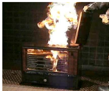
給油タンクのフタが外れ、 こぼれた灯油に引火
