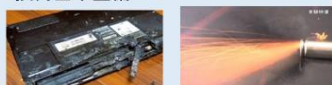
近年増加しているLiB関連製品の発火事故 (左)ノートPC、(右)モバイルバッテリー
