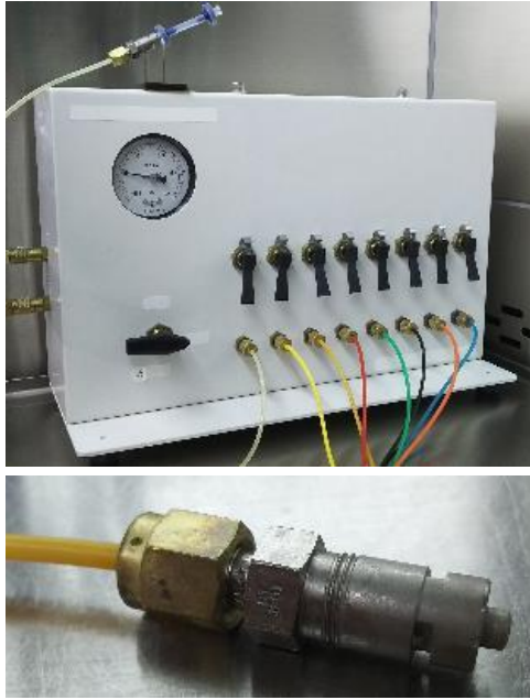
ガス置換装置 (安全キャビネット内で使用)
