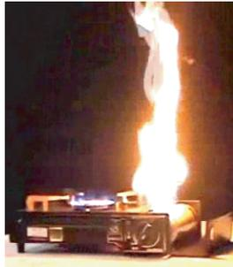
カセットボンベを正しく装着しなかったために漏れたガスに引火しました。(再現実験)
