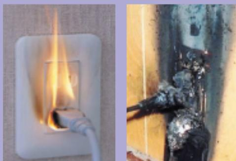
テーブルタップやコンセントに電源プラグを長期間差し込んだままにしていると、コンセントとプラグの周辺にほこりがたまります。そこに水滴や湿気が加わるとプラグの刃と刃の間に電流が流れて火花放電を繰り返します。そうすると、その部分が炭化し、電気が通るようになるため、発火する現象です。
