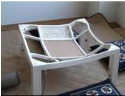
ダクト口を温風暖房機に近づけ過ぎたため(右)に変形したこたつ
