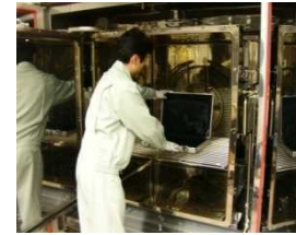
アタッチケースからのVOC等放散測定
