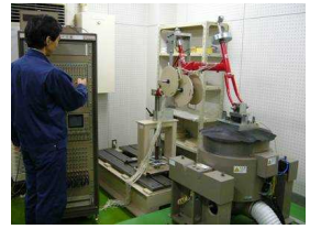
自転車フレーム耐振性試験
