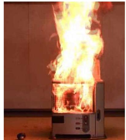
(写真) カートリッジタンクのふたが外れて灯油が高温部にかかり発火
