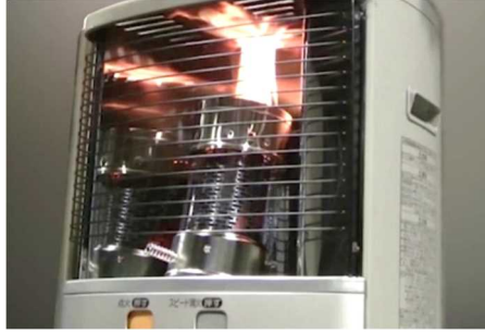
燃焼筒のずれによる異常燃焼
