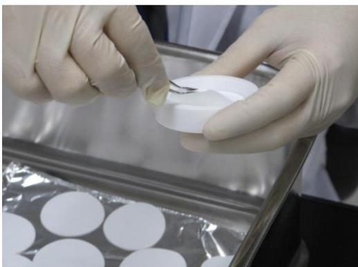
写真 19 シャーレへの固相抽出ディスクの装着
