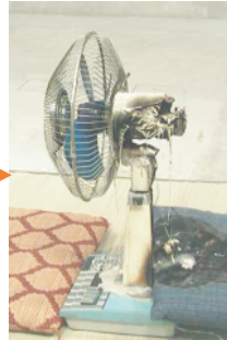
消火後の扇風機
