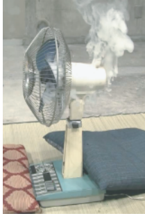
コンデンサーから煙が出ています
