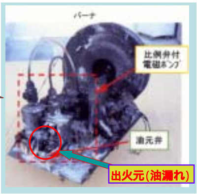
バーナ・電磁ポンプ部拡大
