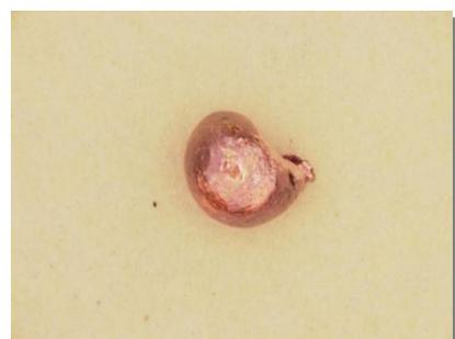
○マイクロニッパなどで予めできるだけ痕跡に近い部位で溶融していない素線部を切断する。さらに拡大鏡や実体顕微鏡を覗きながら痕跡部分を指先でつまむなどして反対の手に持ったマイクログラインダなどで余分な素線を取り除く。こうした非常に細かい作業が必要なことから、比重法はあまりに小さな痕跡には適用できない。
