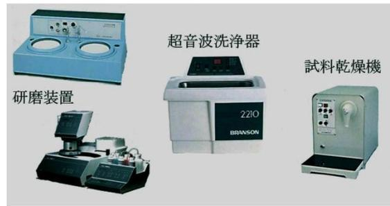
○研磨には手研磨と自動研磨機を用いた機械研磨がある。
