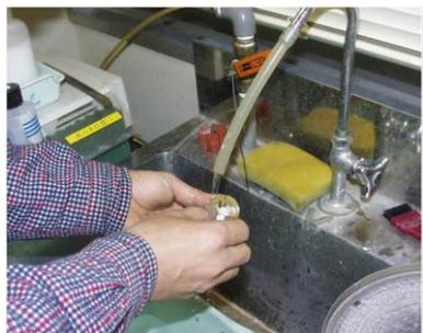
○最終研磨の終了後は、サンプルホルダー上のサンプルを顕微鏡観察し、研磨が良好ならばサンプルを取り外す。
