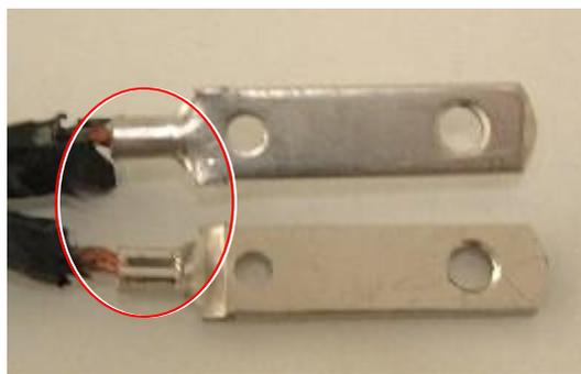
写真4 器具付きプラグでの釘刃とコードの接続例(モールド樹脂を除去した状態)
