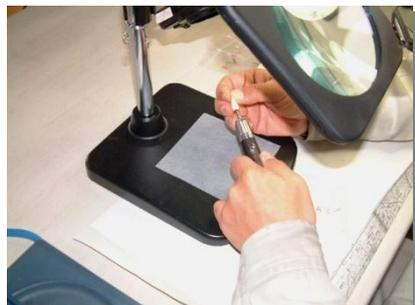
○外観観察の結果から比重法を用いたCS法が適用可能と判断された痕跡は、以降の作業で短絡痕のみの質量測定等を行う必要がある。このため(1)で大雑把に切り出した部分のうち、さらに短絡時に実際に溶融・凝固した部分のみを切り出す必要がある。
