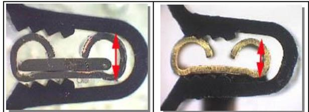
左:写真 12 正常挿入時寸法(平形接続子)
