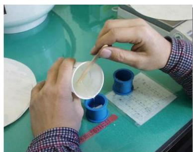
○カップの内壁部分に離型剤を塗布しサンプルを静置したら、静かに樹脂を注入する。このとき、サンプル名、番号等を記入した紙片を入れておくと観察時のサンプルの識別が容易である。
