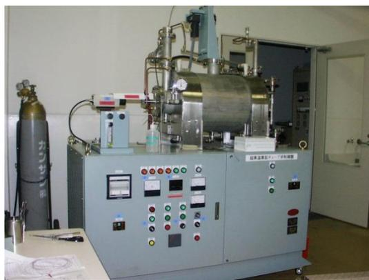
写真2 タンマン炉(例)
