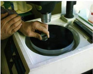
○組織観察の前には研磨面の状況に応じて、手に持ったサンプルをバフを貼った回転中の研磨ディスク上に軽く押しつけて手研磨様の操作を行う。
