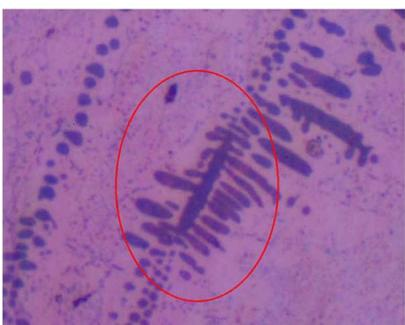
○主軸が明確であって、その両側に二次枝が観察される場合であっても、左右対称でない部分は測定しない。二次枝は通常、主軸の両側に対称的に生じる。主軸の両側に二次枝が観察されている場合でも、両側でDASが異なる場合は測定しない。
