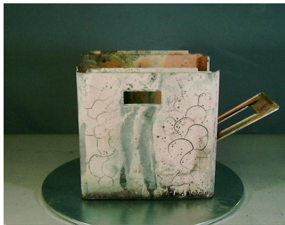
写真2 精米器の外郭鋼板に生じた痕跡
