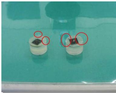
○サンプルカップから取り出したサンプルのエッジ部分にバリが生じていないか確認する。
