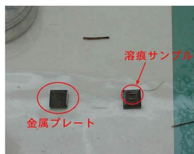
○常温硬化性樹脂を用いてサンプルを作製する場合、抜気操作の際、痕跡が軽量であることから、樹脂内で浮遊、移動することがある。
