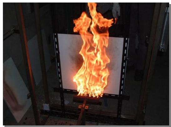
写真5 大型加熱バーナによる実験
