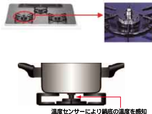
(図2) 天ぷら油過熱防止装置の構造
