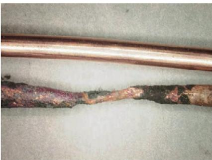
(写真7) 接続不良状態で異常発熱させて発火させたサンプル(例写真の上側は新品試料)
