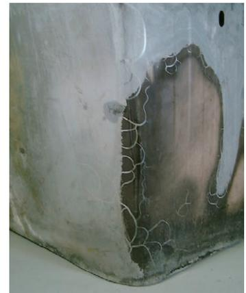
（写真3）事故品洗濯機の外郭鋼板に現れた被熱痕跡
