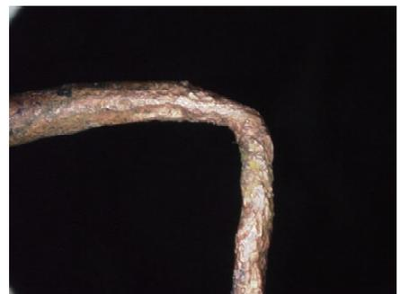
（写真6） 事故品の電源コネクタに接続されていた線
