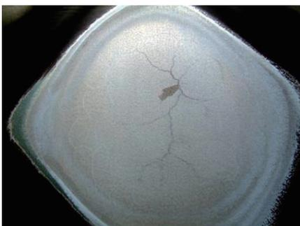
（写真4） 外火想定（バーナ火炎）による加熱で鋼板おもて側に生じた被熱痕跡
