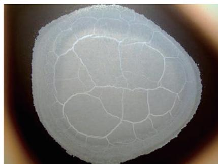
（写真5） 内火想定（バーナ火炎）による加熱で鋼板おもて側に生じた被熱痕跡
