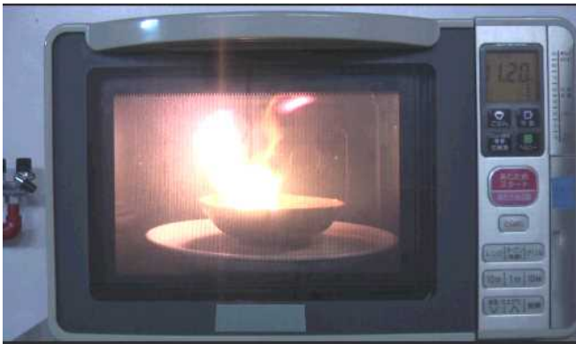
里いも2個を700Wで加熱。6分35秒後に煙が出て、8分30秒後に燃え始めました。
