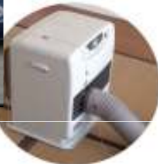
ダクト口を温風暖房機に近づけ過ぎたため(右)に変形したこたつ
