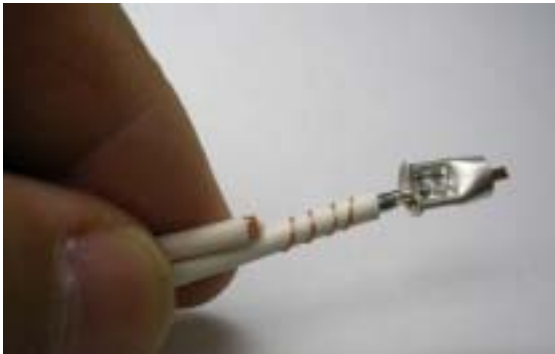
d . はんだの先にE小リングスリーブを取り付ける。
