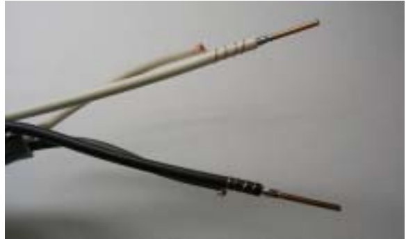
b . より素線先端を単線に巻き付けはんだ付けする。
