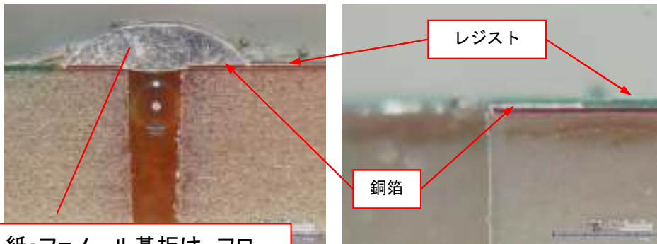
レジスト処理された試料の断面（例）
