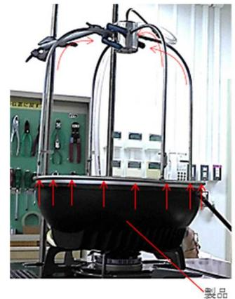
(写真) エコフライパン近傍で CO 濃度を測定する様子
