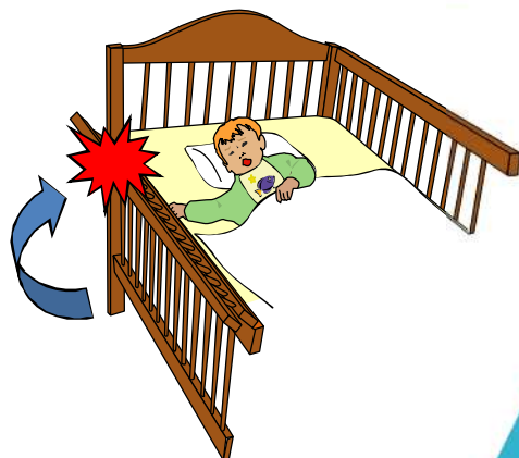
危険源の一例 (機械的危険源—隙間・開口部)
