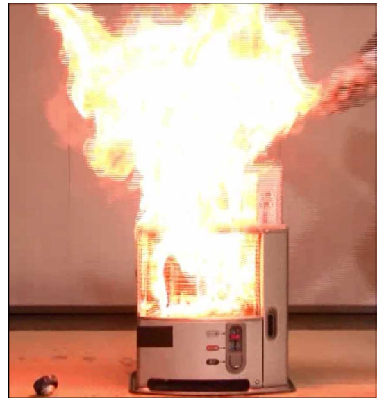
漏れた灯油が石油ストーブの高温部にかかり発火した事故の再現実験
