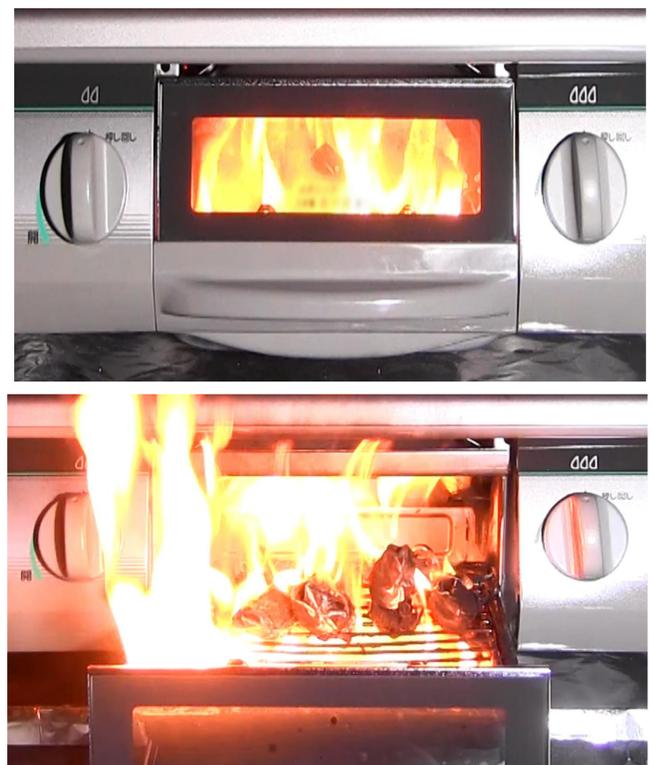
受け皿の油脂が出火し、調理物に燃え移り(写真上)、扉を開けると炎が拡大しました(写真下)
