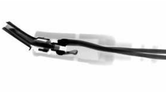
折り曲げたマイクロ USB の X 線写真。 コネクタの変形に伴い、内部のコネクタシェルとコネクタピンが曲がっている。
