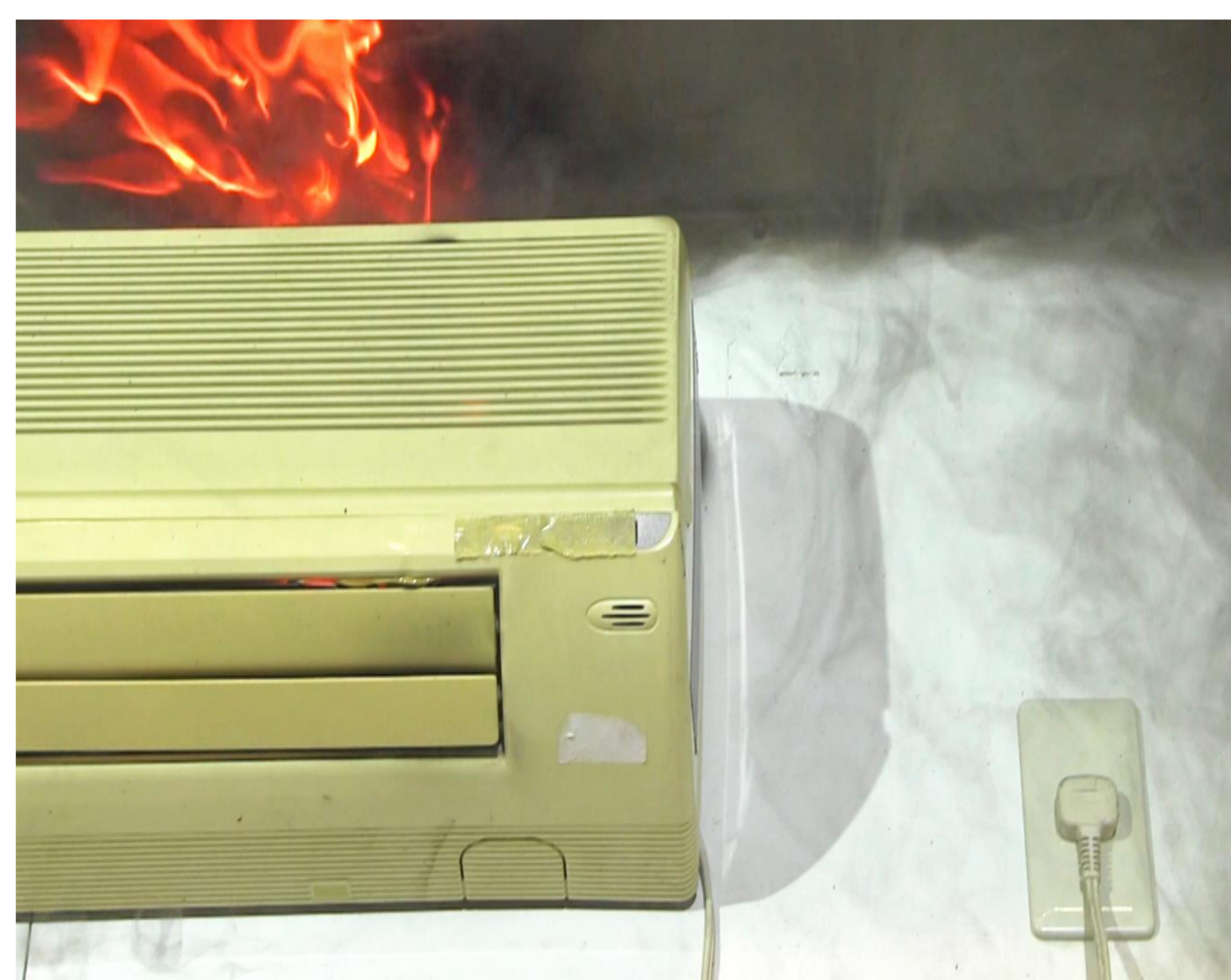
エアコン洗浄剤による事故の再現実験
