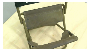
(写真) 劣化した座面に座って、座面が破れたイメージ
