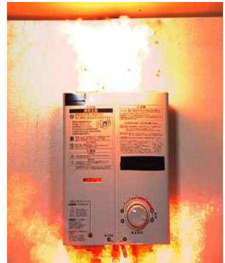
屋内式ガス瞬間湯沸器の爆発着火の様子(イメージ)
