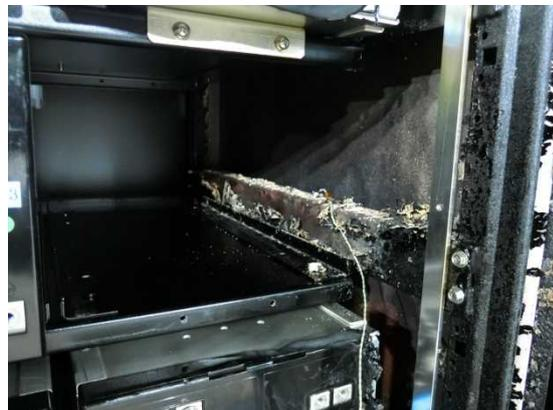
図 1 5. 試験後の試験体内壁
