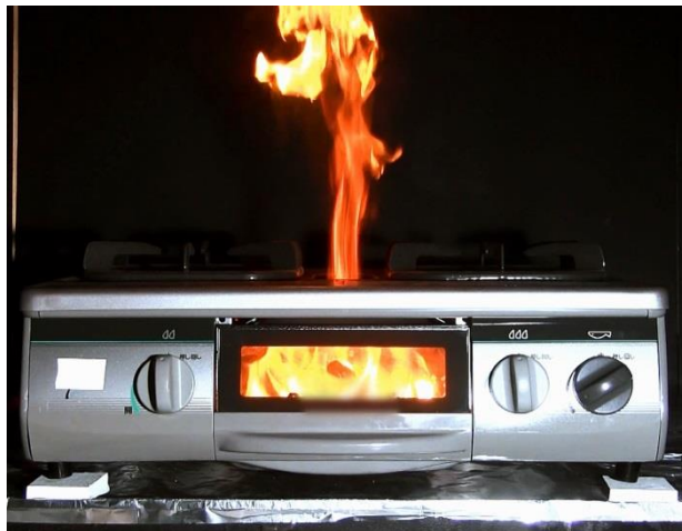
(写真) 魚調理中にグリル庫内に溜まった汚れが過熱されて発火する再現実験
