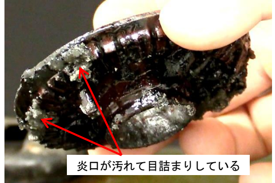
(写真)バーナーキャップの炎口が目詰まりしている様子（イメージ）
