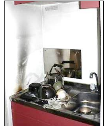
(写真) 電気こんろが通電して周囲の可燃物に着火した様子
