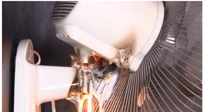
【NITEの再現実験】断線部から発火して、周囲の可燃物に着火する様子。
