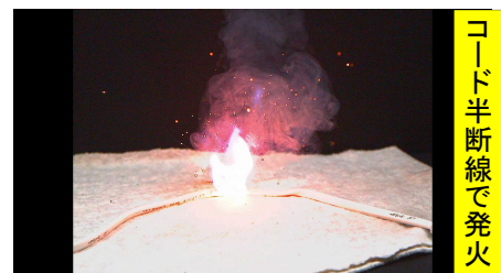
トラッキング現象
