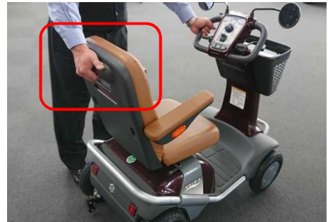
写真 12 シート背面のクラッチを握っている様子
