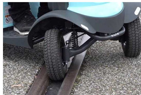
写真2 前輪が線路の溝に挟まっている様子
