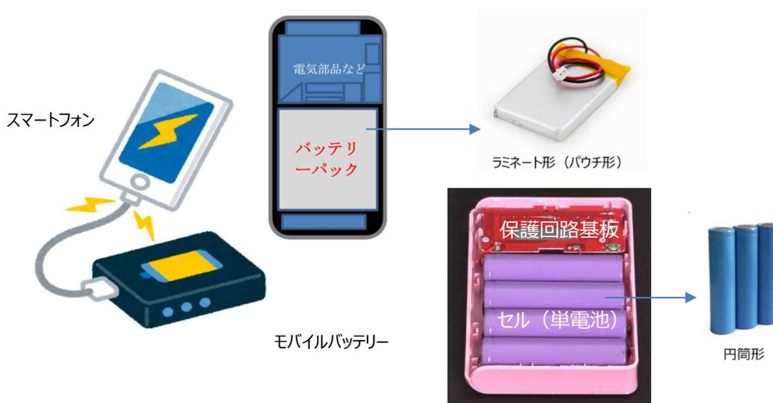
図 1 スマートフォン・モバイルバッテリーの構造
