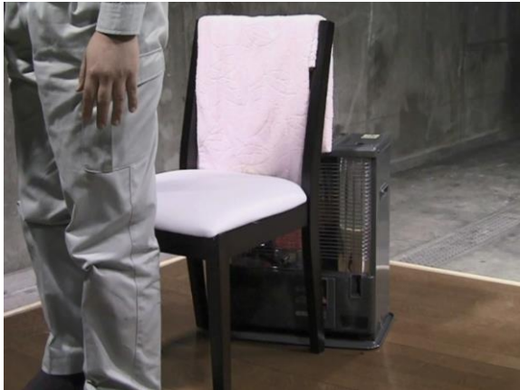
写真1. 可燃物が接触して発火
