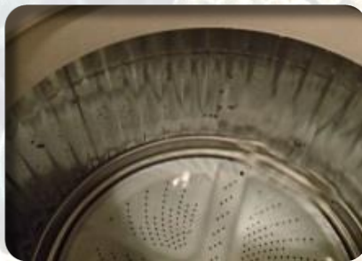
洗濯槽に 生えたカビ
