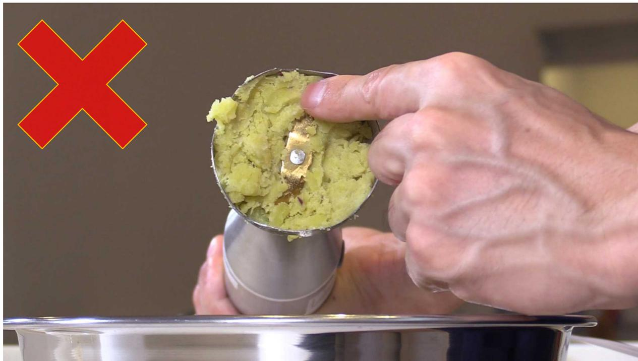
電源コードを接続した状態で刃に触れると、意図せずにスイッチが入りけがをするおそれがあります。
