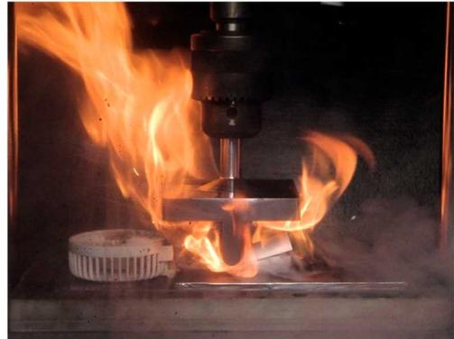
(写真) つぶされたバッテリーの発火事故再現映像
