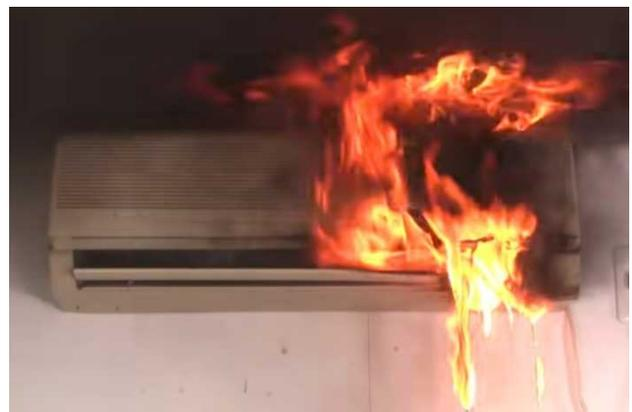
(写真) 内部洗浄の不備による火災事故の再現映像
