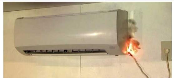
(写真) 電源コードの加工箇所から発火
