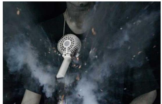
(写真) リチウムイオンバッテリーが破裂
