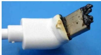
(写真) 導電性の異物の付着により焼損したコネクタ（ケーブル側）
