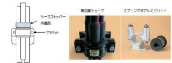
図2 シュリンクバック対策例 写真4 シュリンクバック対策商品例（写真提供：住電機器システム株式会社）
