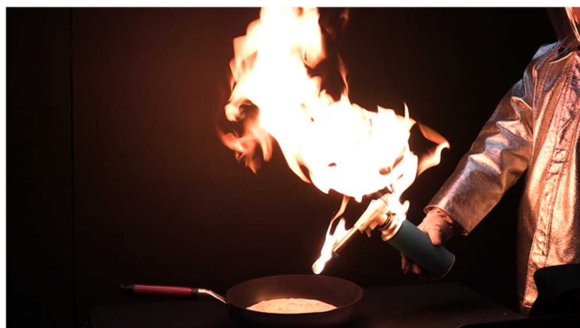
ガストーチから漏れたガスに引火
