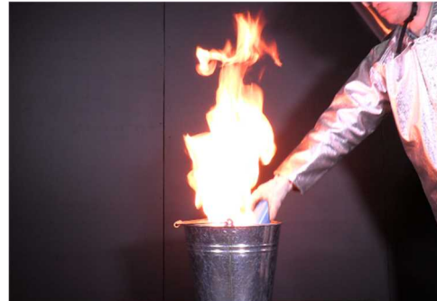
バケツの水面でガスが燃え続ける
