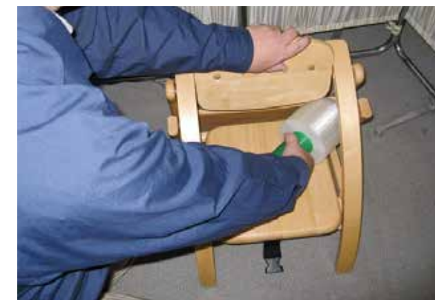
隙間・開口部による乳幼児の身体挟込みに対する試験イメージ
