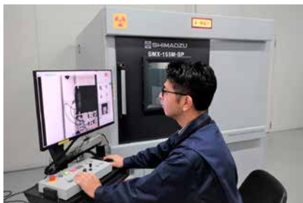
X線透過撮影装置による解析
