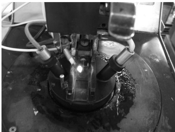
引火点測定試験(第4類)
