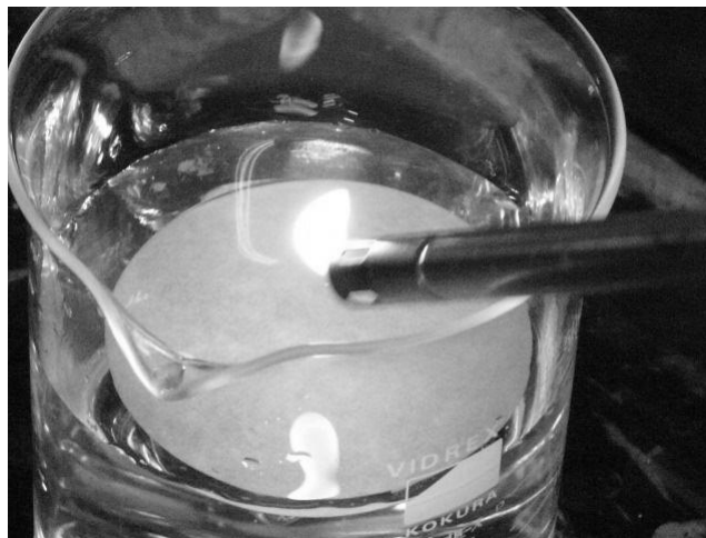
水との反応性試験(第3類)
