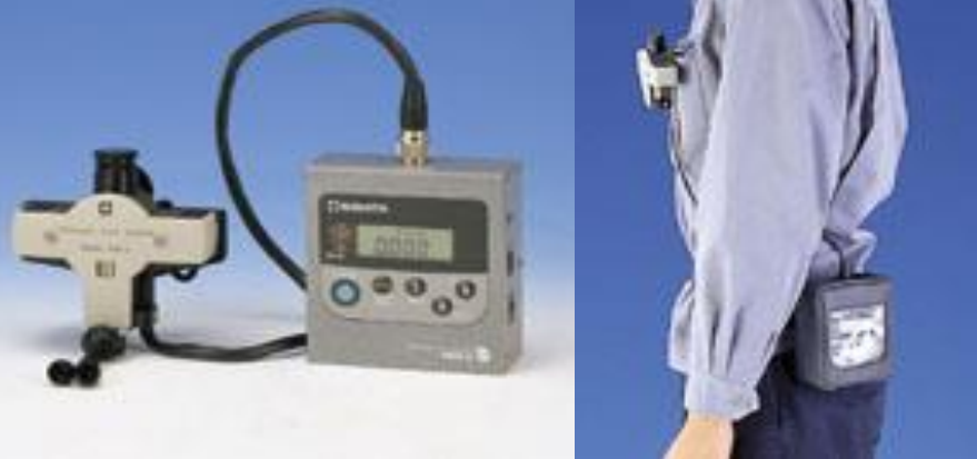
アクティブ粉塵サンプラーによる 個人暴露量サンプリング例（作業環境）
