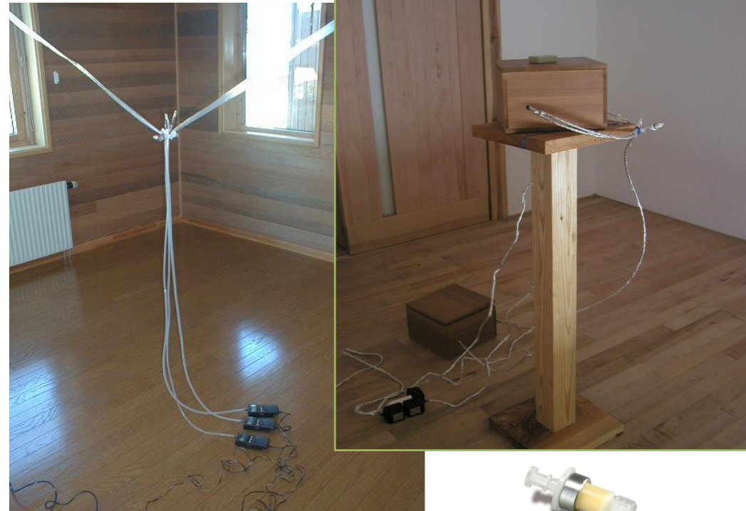
アクティブガスサンプラーによる室内空気質サンプリング例
