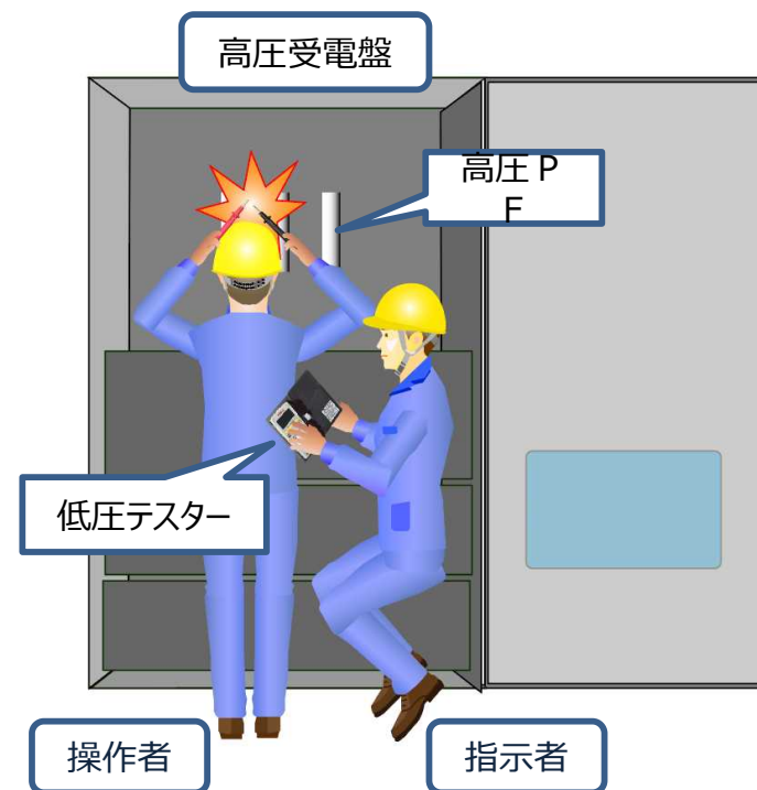
被災時作業状況再現図
