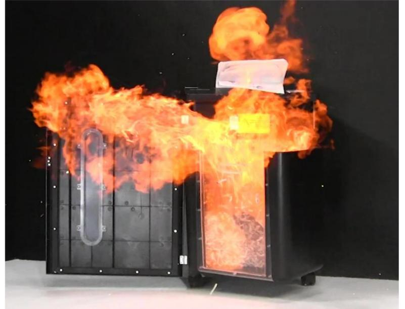
シュレッダーに可燃性ガスを含む潤滑スプレーを使用して引火・爆発
