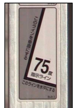
はしごの立てかけ角度と75度の角度指示ラベル例
