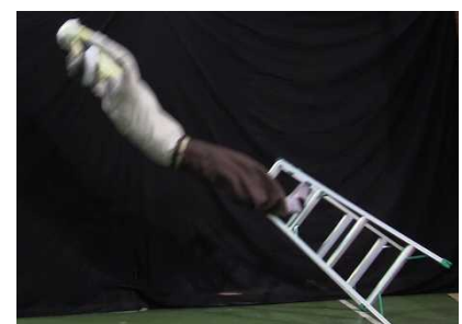
脚立にまたがりバランスを崩して落下
