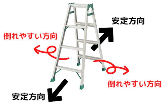
脚立の安定方向・倒れやすい方向
