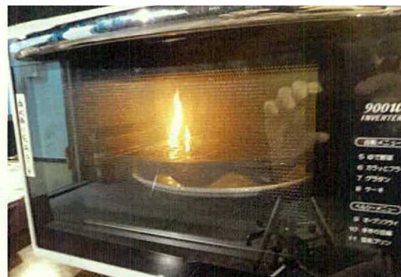
電子レンジ内で発火(再現試験)
