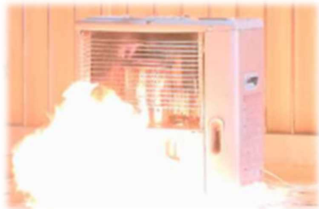
ガソリンを給油して爆発的に燃え上がる様子 (イメージ・NITEプレス資料より)
