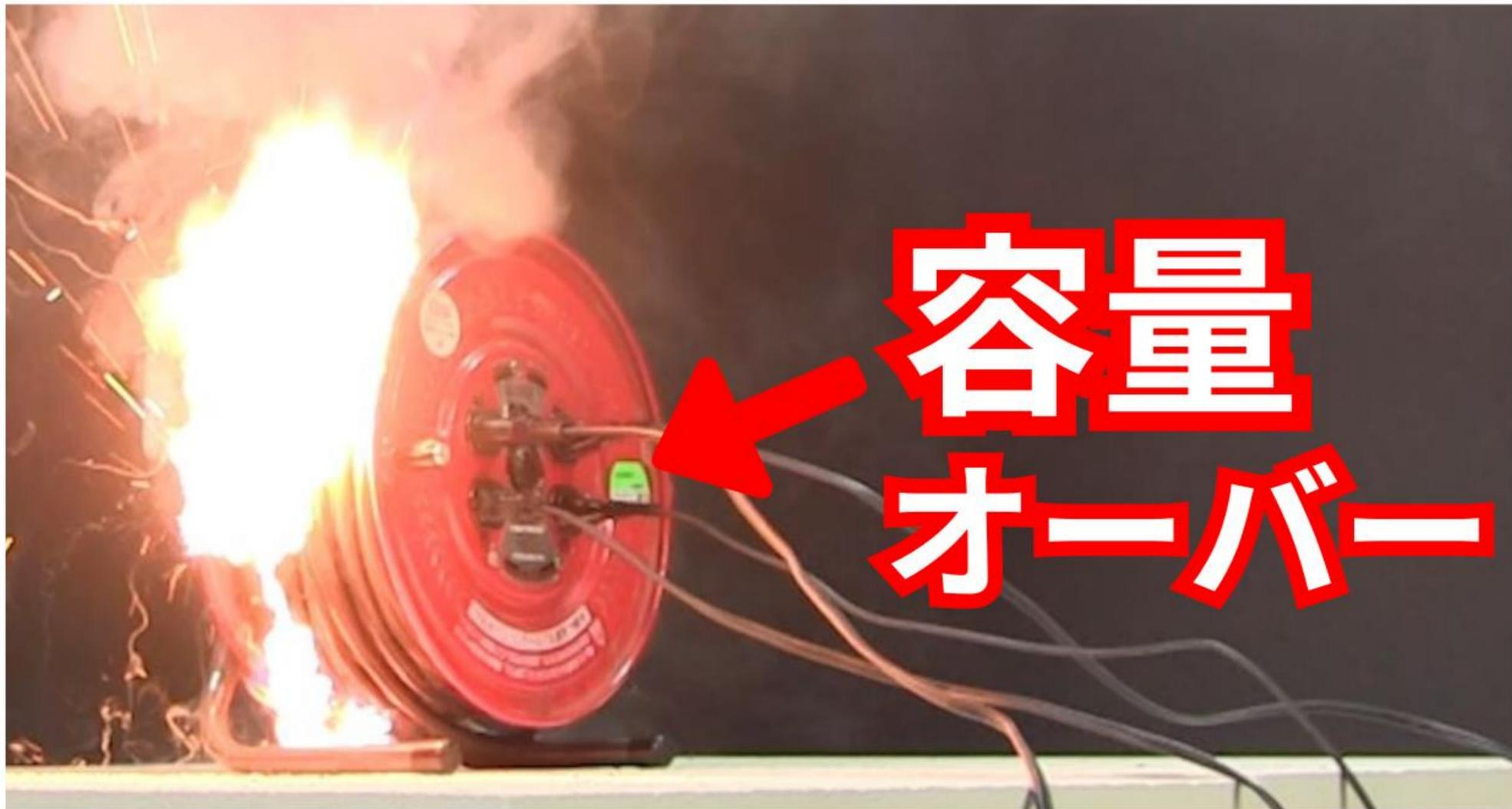
▲コードを引き出さずに消費電力の上限を超えて使用し発火（再現実験）
