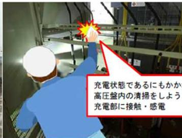
充電状態であるにもかかわらず高圧室内の清掃をしようとして充電部に接触・感電
