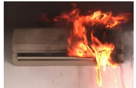
誤った内部洗浄 ※4 により発火する エアコン室内機の再現映像
