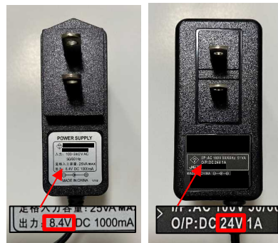
類似の形状でも出力電圧の異なる充電器
